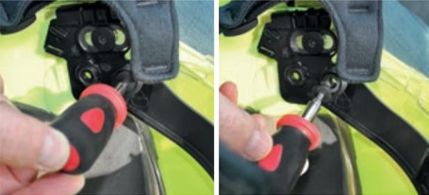
Um die Schutzbrille auszuwechseln, empfiehlt es sich die Innenausstattung auszubauen. Danach lösen Sie die beiden Befestigungsschrauben (Innensechskant) der Schutzbrillenbefestigung und tauschen die Schutzbrille aus. Bauen Sie nun die gesamte Innenausstattung in umgekehrter Reihenfolge wieder ein.
