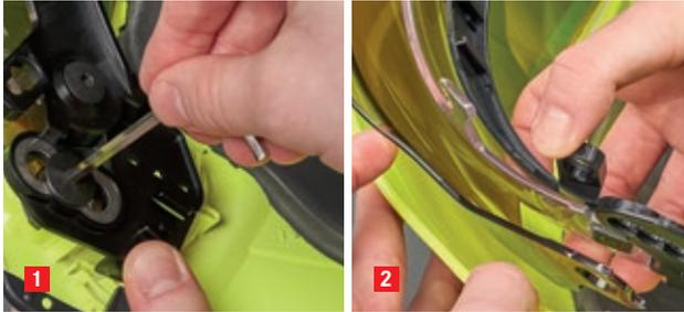
Zuerst müssen die beiden seitlichen Verschraubungen (Innensechskant) gelöst werden siehe Abb. 1. Anschließend Visier aus der Lagerung ziehen siehe Abb. 2.
